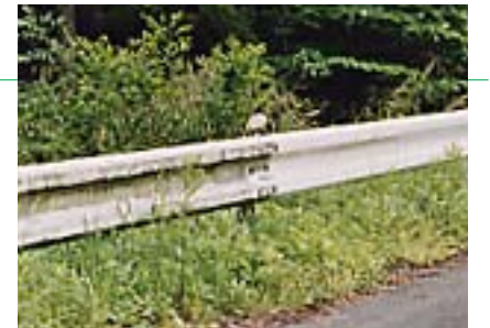
ガードレールにおけるテスト施工。右側のエヌティオの塗装面には藻の発生がみられません。
